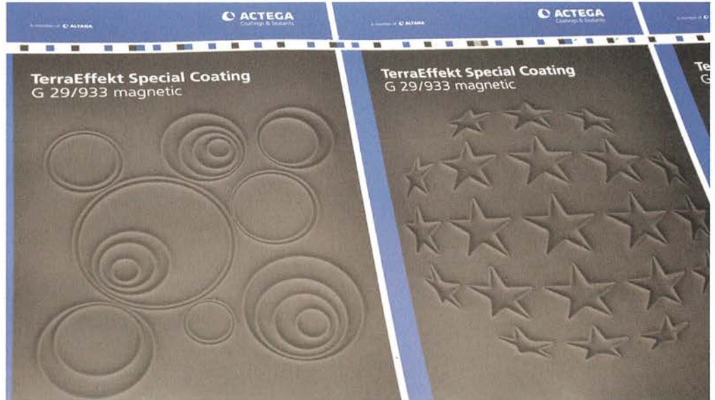
Magnetic-Lack auf Offset-Druckbogen. Deutlich zu sehen: der 3D-Effekt an den Kanten der Designelemente.
