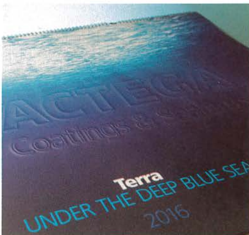
Abbildung links: Dreidimensionale Schriftwirkung durch das Magnetic-Lackierverfahren auf einer starken PVC-Folie. Abbildung Mitte: Wird der Lack per Hand auf Papier aufgebracht, unter dem die Magnetfolie liegt, tritt sofort eine besonders an den Rändern von Schriften und geometrischen Figuren sichtbare 3D-Wirkung auf. Abbildung rechts: Funktionsprinzip (schematische Darstellung „Lackwerk + Magnetfolie“) – Ausrichtung der eisenhaltigen Pigmente im Trägerlack während des Lackierprozesses in einer Bogenoffsetdruckmaschine.
