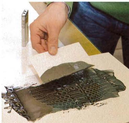
Abbildung links: Dreidimensionale Schriftwirkung durch das Magnetic-Lackierverfahren auf einer starken PVC-Folie. Abbildung Mitte: Wird der Lack per Hand auf Papier aufgebracht, unter dem die Magnetfolie liegt, tritt sofort eine besonders an den Rändern von Schriften und geometrischen Figuren sichtbare 3D-Wirkung auf. Abbildung rechts: Funktionsprinzip (schematische Darstellung „Lackwerk + Magnetfolie“) – Ausrichtung der eisenhaltigen Pigmente im Trägerlack während des Lackierprozesses in einer Bogenoffsetdruckmaschine.
